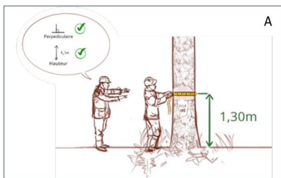
Figure 23. Opération de mesure du diamètre. Un opérateur à l'aide du ruban diamétrique s'occupe de la mesure et un autre en retrait vérifie que le ruban est bien positionné à la hauteur de mesure et perpendiculairement à l'axe de l'arbre.
