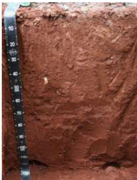
**Figure 3 : Ferralsol, le sol représentatif de Pallisco-Mindourou (Profil Pallisco1)**
