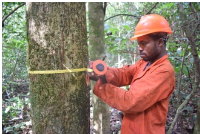
Figure 7 : Photo montrant la mesure du DBH d'un arbre à l'aide d'un ruban diamétrique par un prospecteur.
